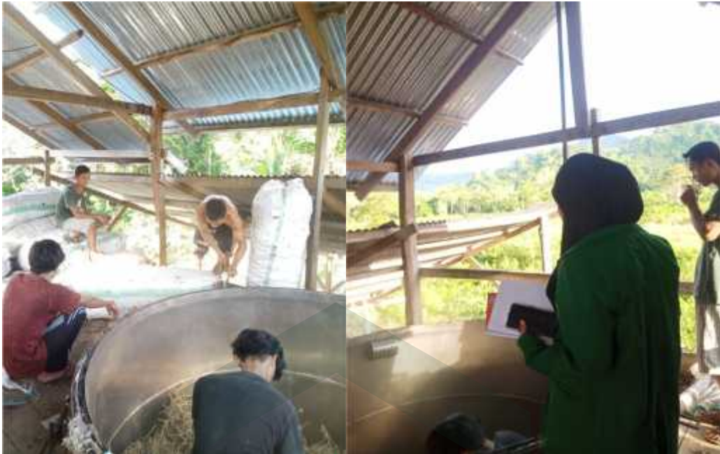
Proses pemasukan bahan baku kedalam tangki penggilingan minyak nilam
