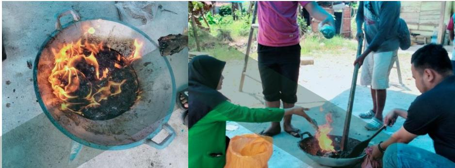
Gambar 4.6 Proses Pencampuran Bubur Sampah Plastik dan Pasir
