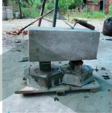
Gambar 4.10 Proses Mendinginkan Pres-an dengan Beban 10 Kg
